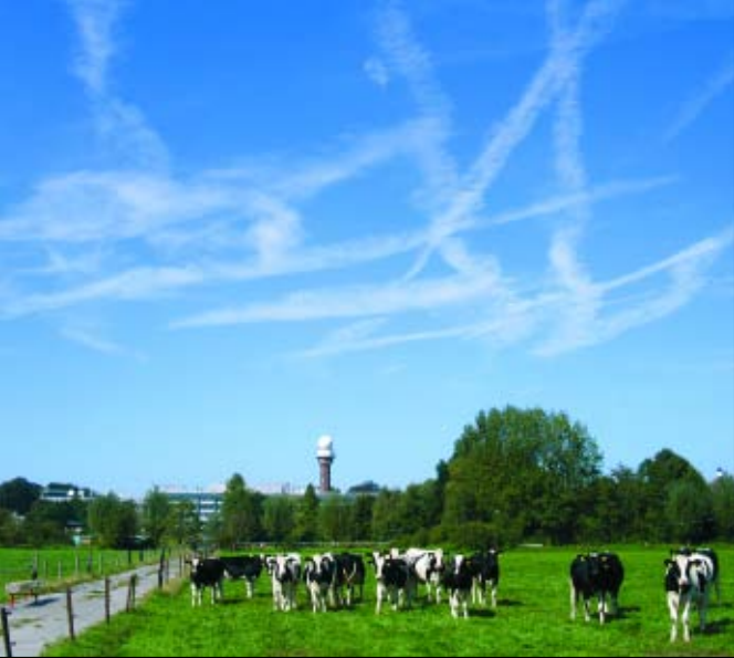
1. De radartoren van het KNMI in De Bilt is al van verre te zien. In de witte bol zitten de zendantenne en ontvanger van de radar.
