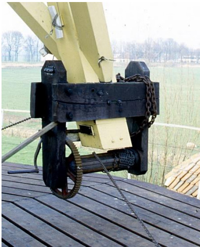
'Kruibok' windas en Tandwieloverbrenging
