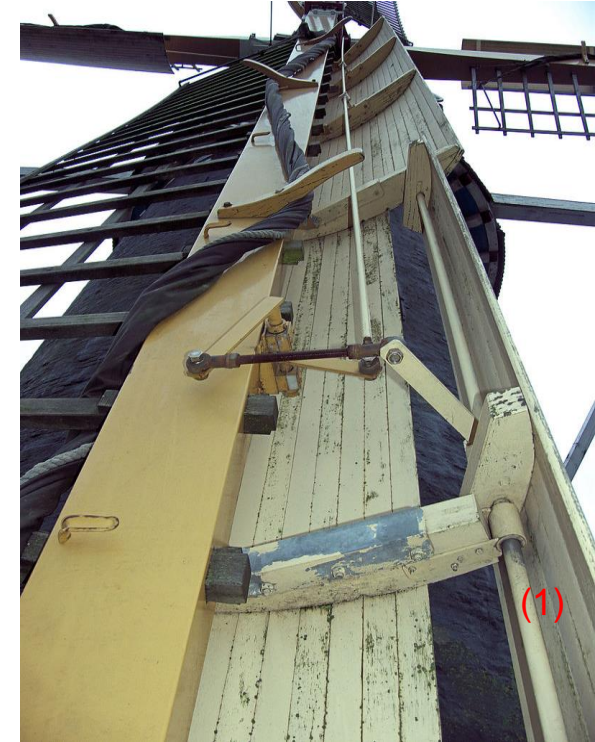
Fok met geopende remklep Foto: Rasbak
